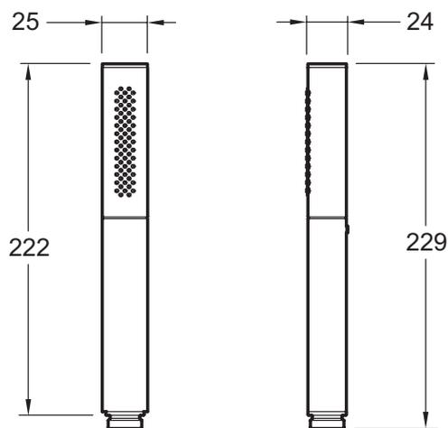
Спецификация продукта: Ручной душ Shift Square с двумя режимами. E14788. Коллекция: SHIFT SQUARE. РАЗМЕРЫ (CM): 22,90 x 2,50 x 2,40 см. ВЕС: 0,3 кг. АКССУАРЫ: РУЧНОЙ ДУШ. НАЛИЧИЕ СМЕСИТЕЛЯ: СО СМЕСИТЕЛЕМ. ОДНОРЫЧАЖНЫЙ СМЕСИТЕЛЬ: ОДНОРЫЧАЖНЫЙ ТЕРМОСТАТ. КЛАССИФИКАЦИЯ: 0. ФОРМА ВЕРХНЕГО ДУША: 0. ПЕРЕКЛЮЧАТЕЛЬ: 0. ТИП ШЛАНГА: 0.
