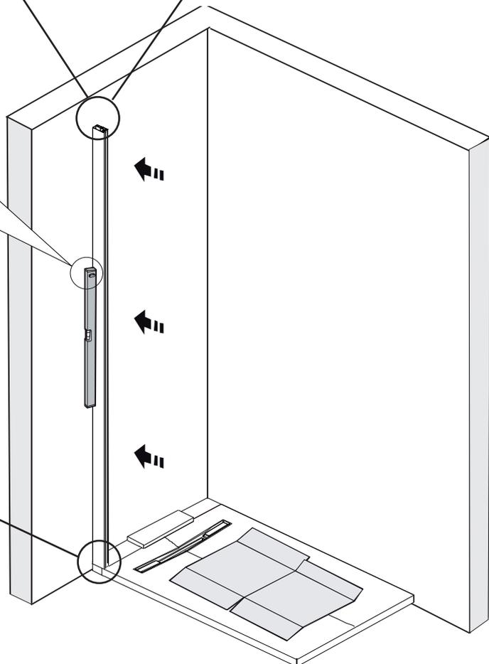
Le profilé doit être affleurant avec le receveur.
