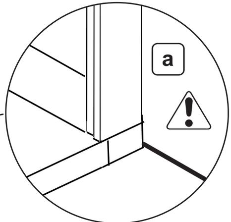
Le profilé doit être affleurant avec le receveur
