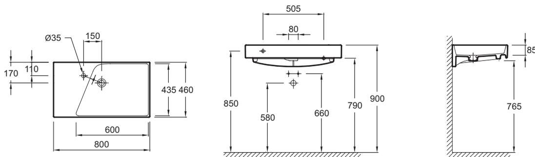
Спецификация продукта: Подвесная раковина-столешница 80 x 46 см, гладкая нижняя поверхность. EX0112-Z. Коллекция: RYTHMIK. Размеры (см): 80 x 46 см. Вес: 22,2 кг. Разметка сверления отверстия для смесителя: С 1 отверстием для смесителя слева. Подвесная раковина-столешница. Может устанавливаться на мебель.
