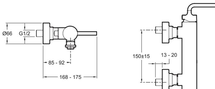
Спецификация продукта: Настенный смеситель для душа. E14590-4A. Коллекция: PURIST. Размеры (см): х х см. Вес: 3,1 кг. Расход воды: 14 л/мин при давлении 3 бар. Механизм: Последовательный керамический картридж. Разметка отверстий: 150 ± 15 мм.
