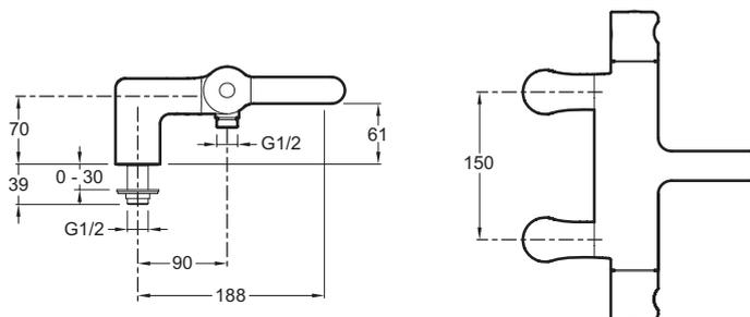
Спецификация продукта: Термостатический смеситель для ванны/душа, устанавливаемый на деку. E10871. Коллекция: SINGULIER. ВЕС: 4,6 кг. РАСХОД ВОДЫ: 20 л/мин при давлении 3 бар. МЕХАНИЗМ: Новый уменьшенный термостатический картридж. РАЗМЕТКА ОТВЕРСТИЙ: 150 мм. СЛИВ: 0. ОДНОРЫЧАЖНЫЙ СМЕСИТЕЛЬ: ТЕРМОСТАТИЧЕСКИЙ ОДНОРЫЧАЖНЫЙ СМЕСИТЕЛЬ. УСТАНОВКА: 0. ГАРАНТИЯ НА ОТДЕЛКУ: 10 лет.
